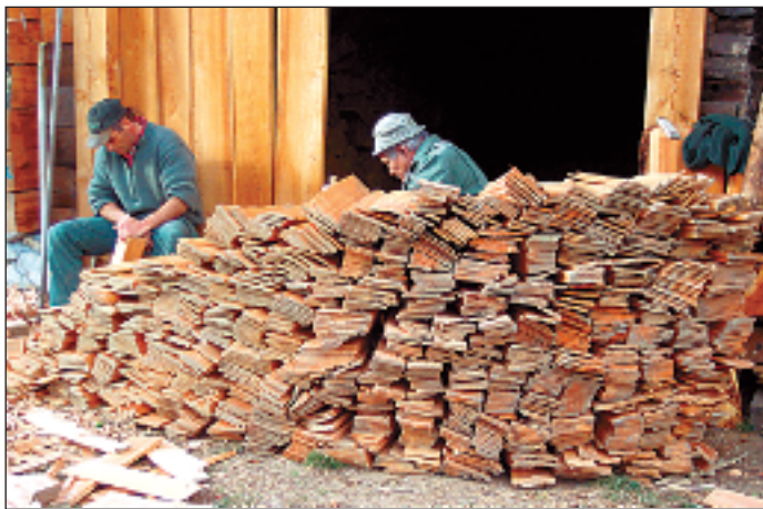
Gewissensfrage neues Dach: Aus Kanada Schindeln einfliegen – oder 5000 Stück selber machen... Clemenz und Helmut Kiechler beim Schindeln von einheimischem Lärch.
